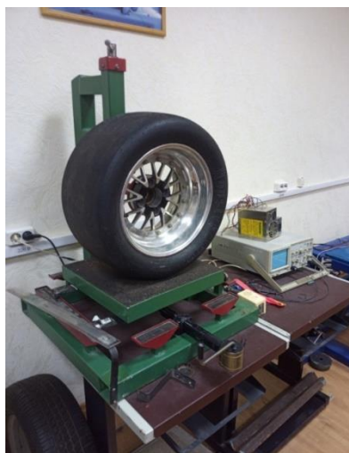
Рисунок 1 – Лабораторный стенд для автомобильных шин
