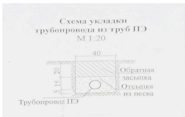
Рисунок 2. Схема укладки из труб ПЭ
