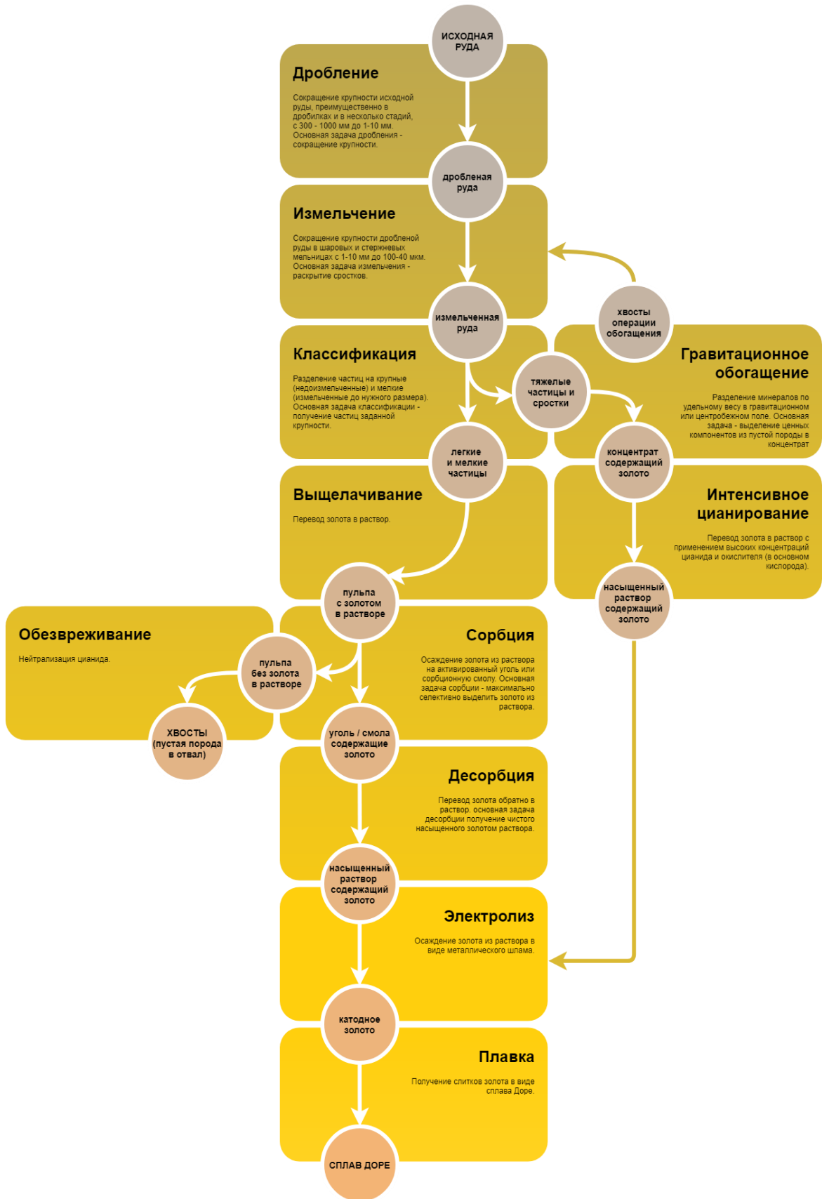
Рис. 6 - Типовая блок-схема переработки рудного золота на ЗИФе в большинстве горнодобывающих предприятий
