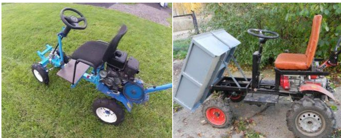
Рисунок 1 – Адаптеры переднего расположения: а) передний адаптер с фронтальной и задней навеской; б) передний адаптер для транспортных и сельскохозяйственных работ
