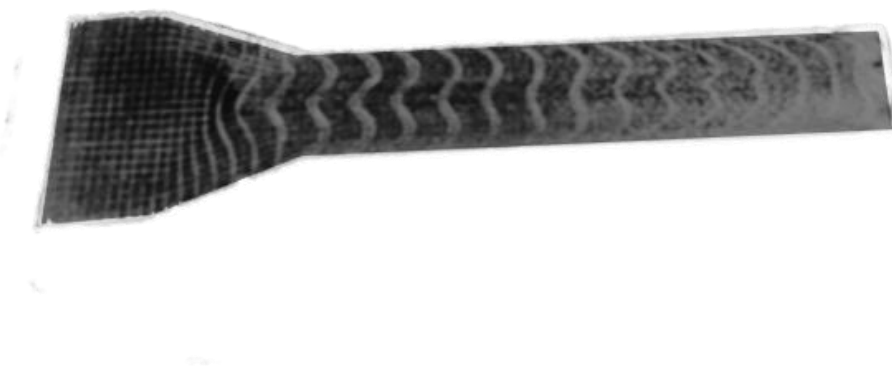
Рисунок 2 Деформированная сетка образца после прямого выдавливания. ( \mu = 0,05 , v_{\text{п}} = 12 мм/с, R_{\text{обл}} = 73 %).
