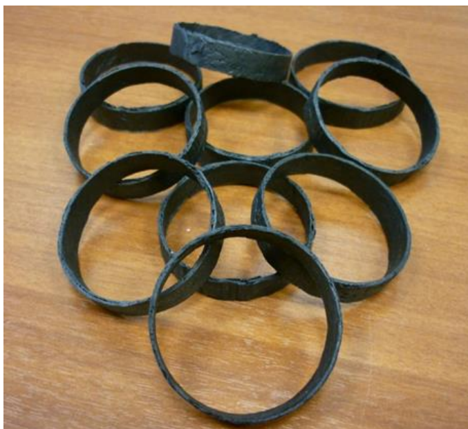
Рисунок 9 – Кольцевые образцы с укладкой (+45;-45;0;+45;-45;0;+45;-45) из ККМ SiC/SiC
