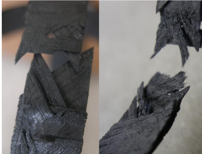
Рисунок 11 – Разрушенные фрагменты кольцевых образцов
