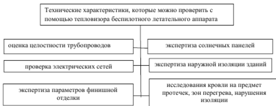
Рисунок 4- Технические характеристики, которые можно проверить с помощью тепловизора беспилотного летательного аппарата
