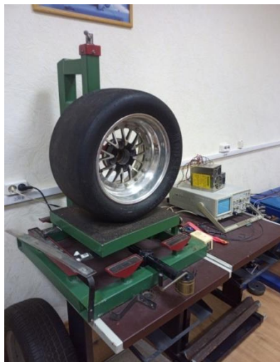
Рисунок 1 – Лабораторный стенд для автомобильных шин
