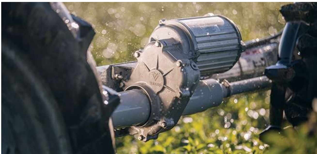
Рисунок 1 – Электромеханический привод ходовой тележки X-Тес, используемый на широкозахватных дождевальными машинами Valley (Valmont Irrigation)
