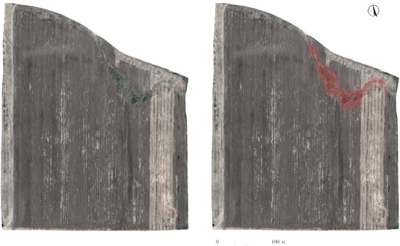
Рисунок 7 – Спутниковый снимок «true color» с наложением контура эродированного участка (Б), полученного после обработки данных вегетационного индекса
