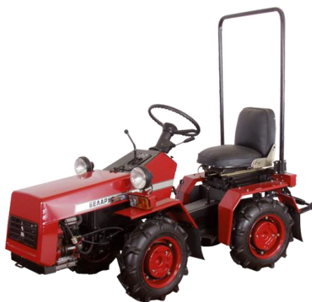
Рисунок 3 – Малогабаритный трактор «Беларус-132Н
