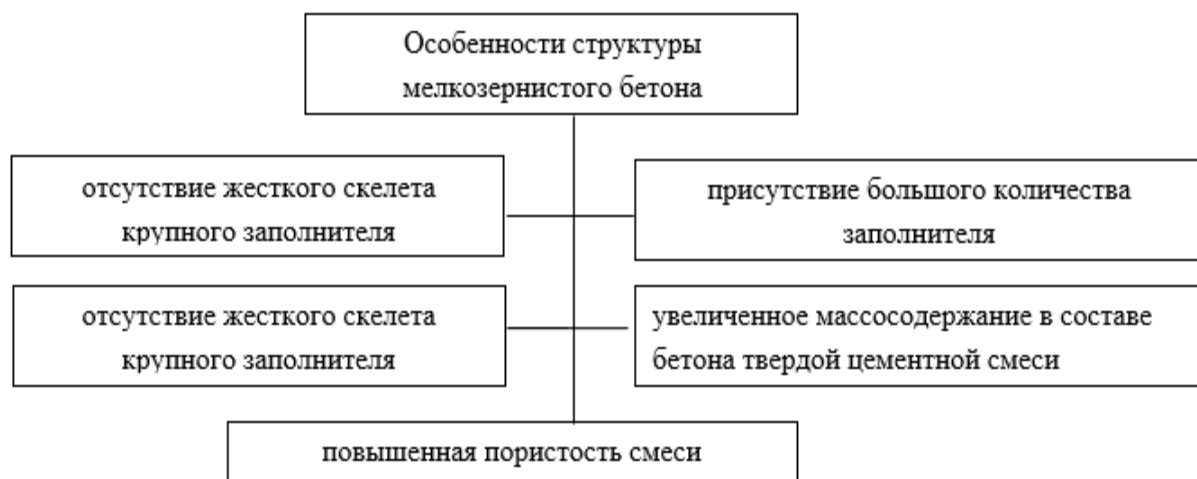
Рисунок 1 - Мелкозернистые бетоны имеют особенности структуры
