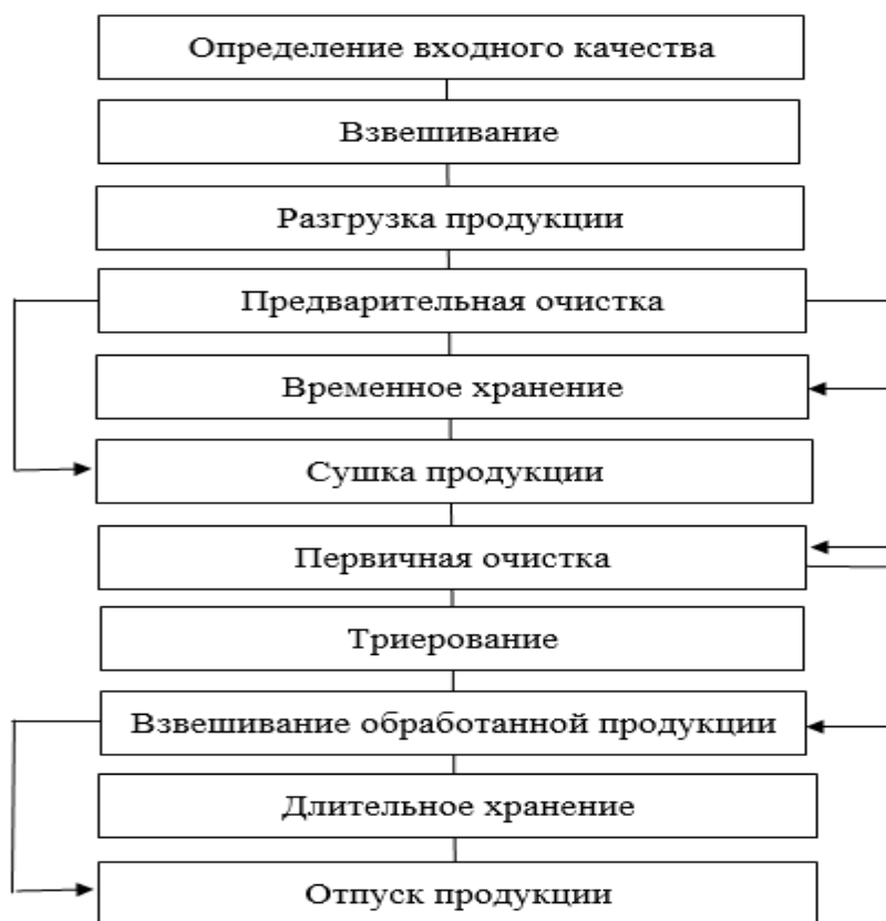
Рисунок 2 – Принципиальная схема технологического процесса обработки продовольственного зерна зерновых, зернобобовых и маслосемян подсолнечника
