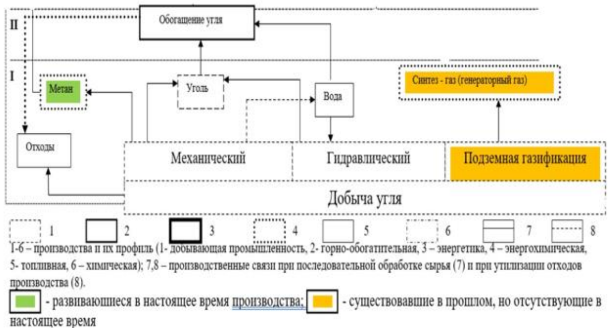
Рисунок 1 - Первая (I) и вторая (II) стадии углеэнергохимического цикла в Кемеровской области – Кузбассе (составлено авторами).
