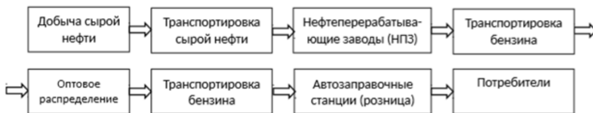
Рис.1 Этапы производства бензина
