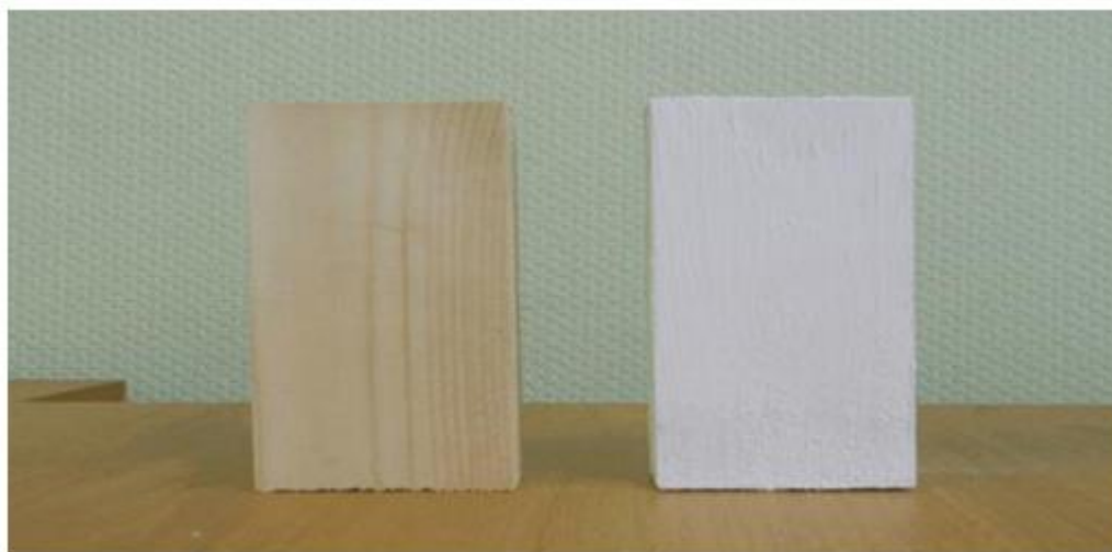
Рисунок 2 - Древесина с огнезащитным покрытием «Нертекс-Д»
