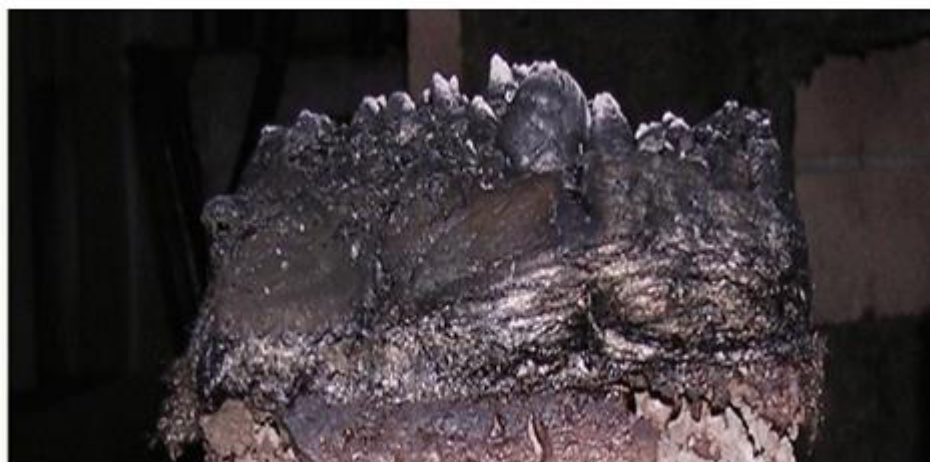
Рисунок 1- Вспененный слой огнезащитного покрытия «Нертекс»
