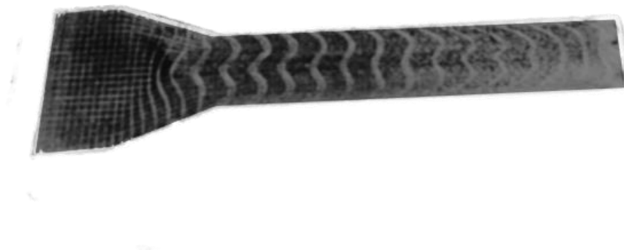
Рисунок 2 Деформированная сетка образца после прямого выдавливания. ( \mu = 0,05 , v_{II} = 12 мм/с, R_{обл} = 73 %).
