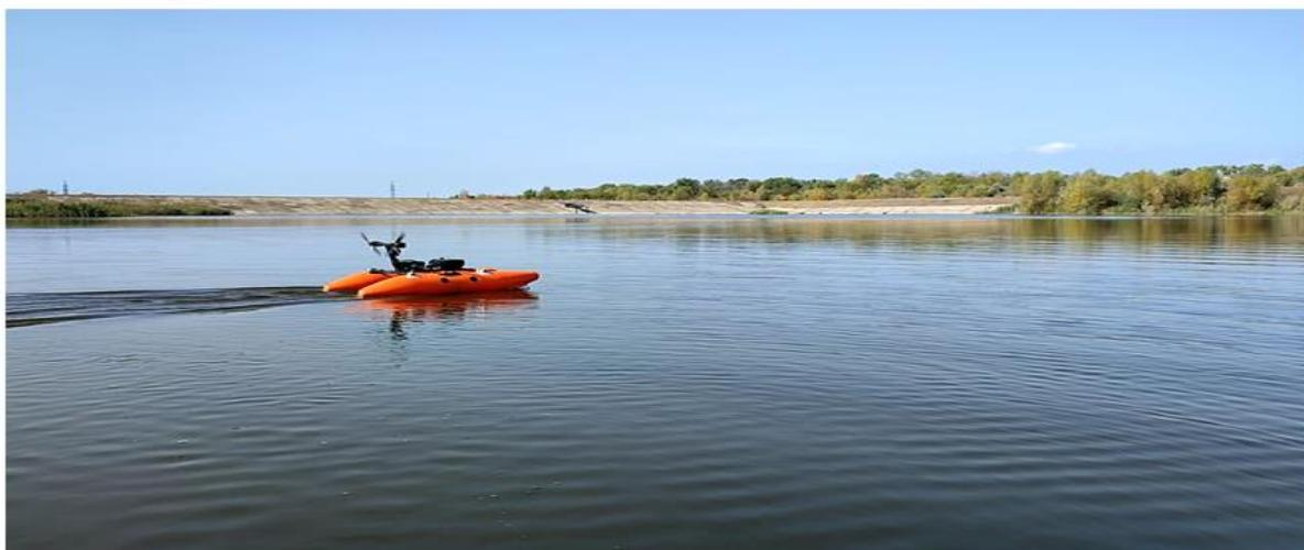
**Рисунок 1 – Беспилотный роботизированный гидрографический комплекс при выполнении промеров глубин на водохранилище на овраге Мечетка, октябрь 2023 г.**
