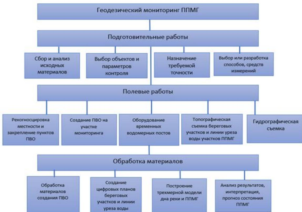
**Рисунок 2. Технологическая схема геодезического мониторинга ППМГ**
