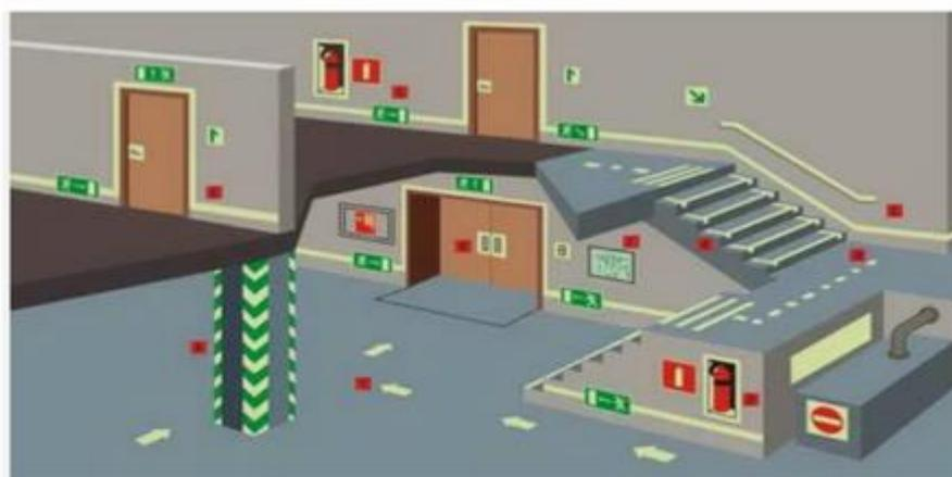
Рисунок 1 – Пример эвакуационных путей и выходов, а также движения по ним [5]
