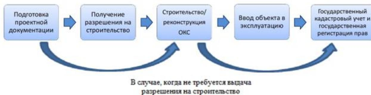
Рисунок 1. Технологическая схема процесса строительства/реконструкции и регистрации ОКС
