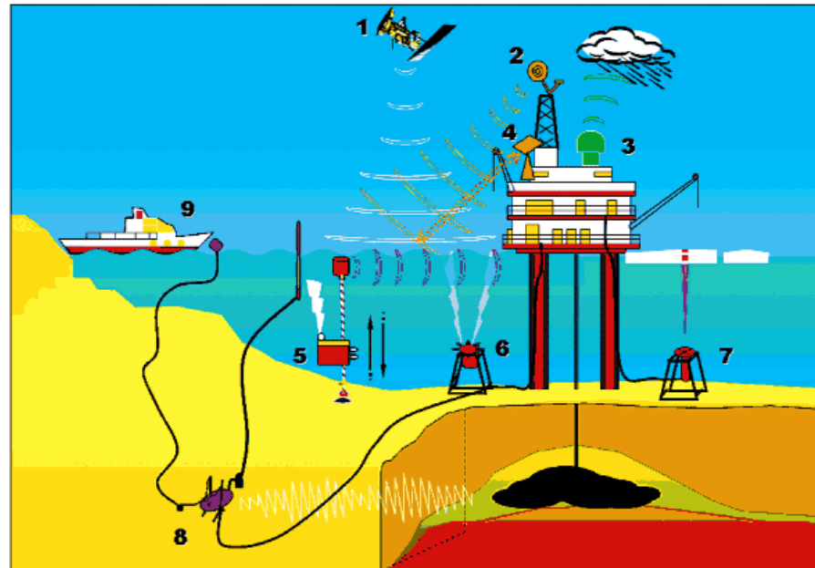
Рисунок 1. Многоуровневая структура системы экологического мониторинга для нефтедобывающих платформ на морском шельфе.
