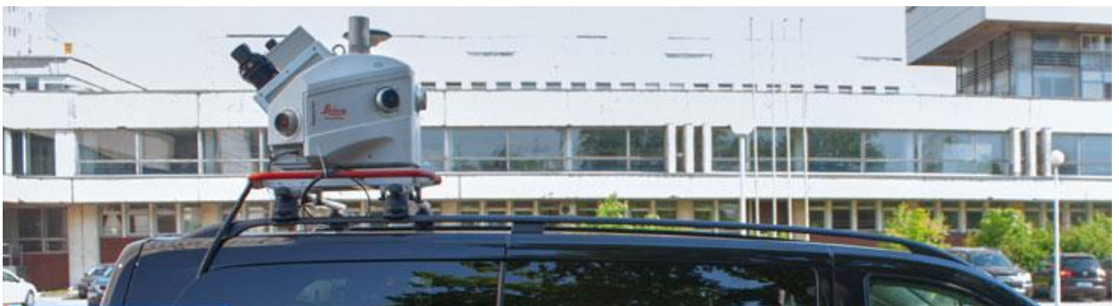
Рисунок 2. Мобильный лазерный сканер на автомобиле
