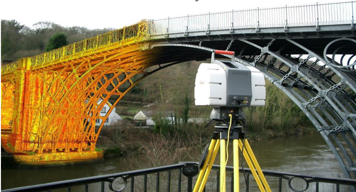
Рисунок 1. Наземный лазерный сканер на штативе
