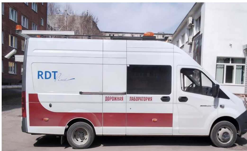
Рис. 1. Общий вид передвижной дорожной лаборатории КП-514-RDT, использованной в исследовании
