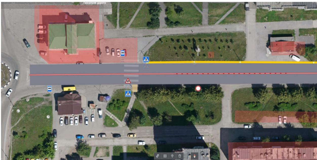
Рисунок 2. Пример графической визуализации контура автомобильной дороги на ортофотоплане после обработки изображения
