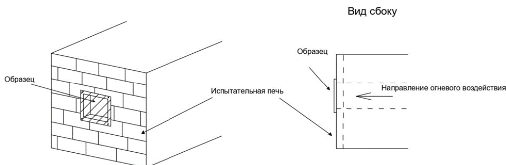
Рисунок 2 – Схема конструкционного исполнения образца
