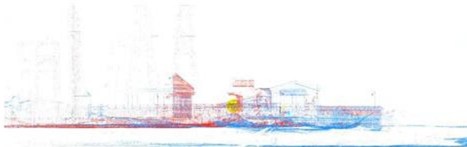
Рис. 3. Цифровая модель нефтегазовых объектов, состоящая из облака точек
